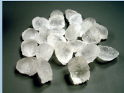
Der Werkstoff, der die Rhepanol-Dachbahnen so besonders macht: Polyisobutylene (PIB).
